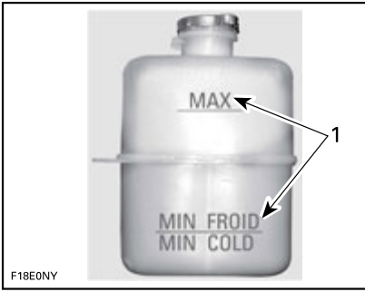
TÍPICO - DEPÓSITO DE EXPANSIÓN DE REFRIGERANTE
