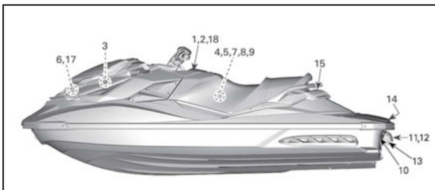
VATTENSKOTERNS SÄKERHETSDEKALERS PLACERING - GTR-X-MODELLEN
