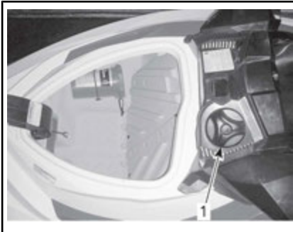
TYPBILD - BRÄNSLETANKSLOCKETS PLACERING
