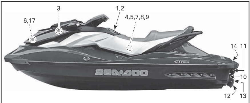
LOCALIZAÇÃO DA ETIQUETA DE SEGURANÇA DO JET - MODELOS GTI
