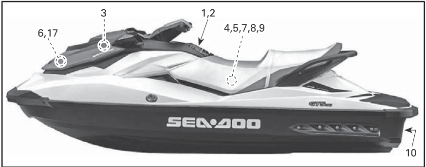
LOCALIZAÇÃO DA ETIQUETA DE SEGURANÇA DO JET - MODELOS GTS
