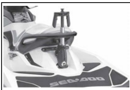
TYYPILLINEN - SUKSI-/VESILAUTAPIDIN ULOS VEDETTYNÄ
