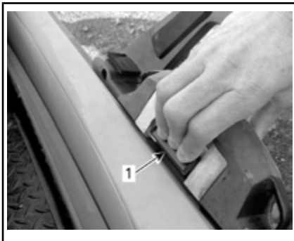
尾部波板架拆卸
