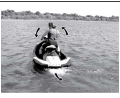
TYPBILD - STYRRIKTNINGEN OMKASTAD VID BACKNING
