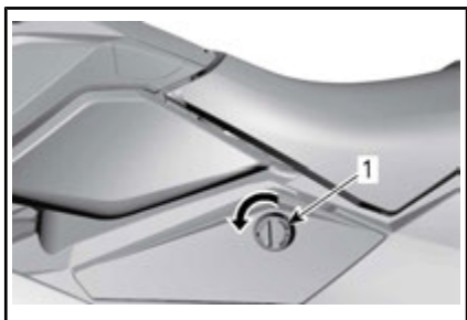
TAMPA DE ACESSO ESQUERDA
