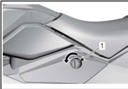
TAMPA DE ACESSO ESQUERDA
