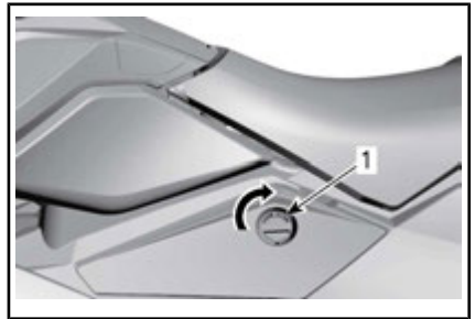
TAMPA DE ACESSO ESQUERDA
