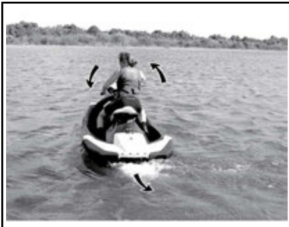
代表例 - 後退時、反対側にステアリングを切る
