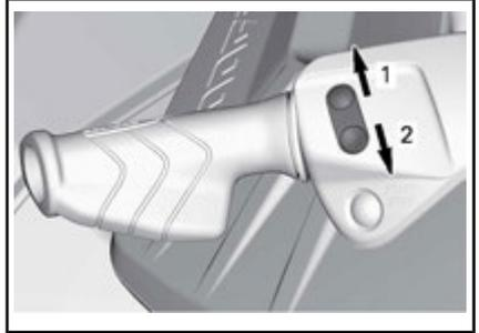
**PULSE EL BOTÓN DE VTS DOS VECES HACIA ARRIBA O HACIA ABAJO PARA UTILIZAR LAS POSICIONES PREDEFINIDAS.**
