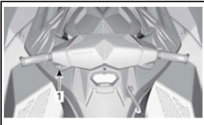
TYPISCH 1. START-/STOP-Taste des Motors
