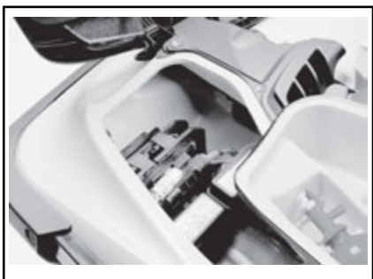
ACESSO À BATERIA E FUSÍVEIS - COMPARTIMENTO DIREITO REMOVIDO
