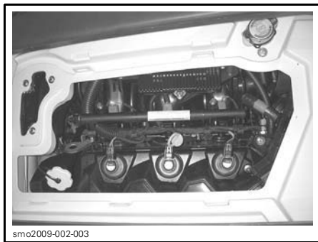
BOÎTE DE VENTILATION RETIRÉE
