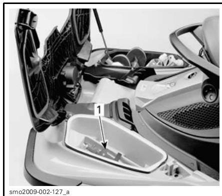
1. Emplacement du support d'extincteur
