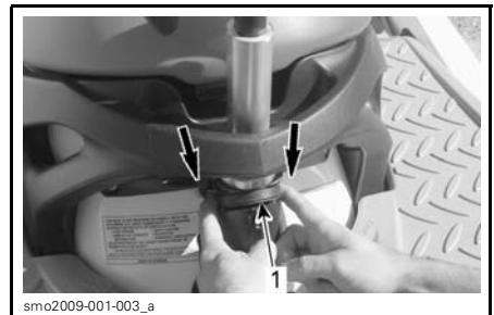
POUSSER VERS L'AVANT POUR DÉVERROUILLER ET ENLEVER LE POTEAU 1. Goupille de verrouillage
