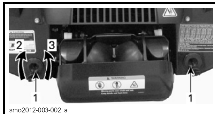
TYPEBILDE – PLASSERING AV DRENERINGSPLUGGER FOR BUNNVANN
