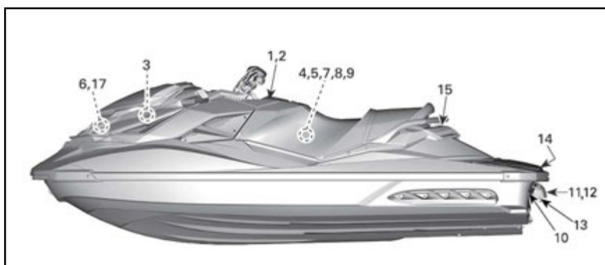
LOCALIZAÇÃO DA ETIQUETA DE SEGURANÇA DA MOTO AQUÁTICA - MODELO GTR-X
