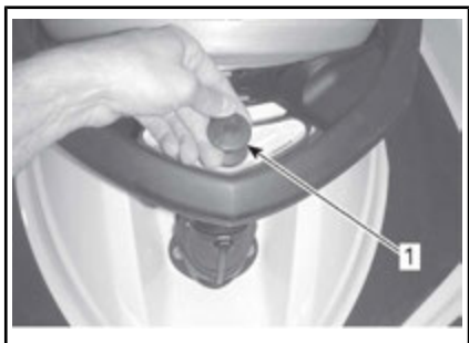
TYPEBILDE – UTTRUKKET STOLPE FOR VANNSKI/BØLGEBRETT
