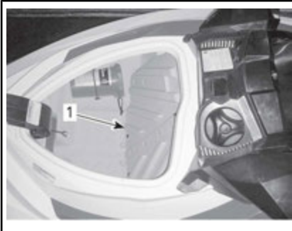
TILGANG TIL BATTERI OG SIKRINGER, OPPBEVARINGSROM FORAN
