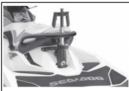
TYPEBILDE – UTTRUKKET STOLPE FOR VANNSKI/BØLGEBRETT
