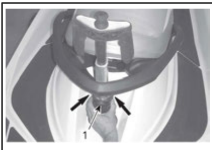
代表的な例-ポストを前方へ押ししてロックを解除し、取り外す
