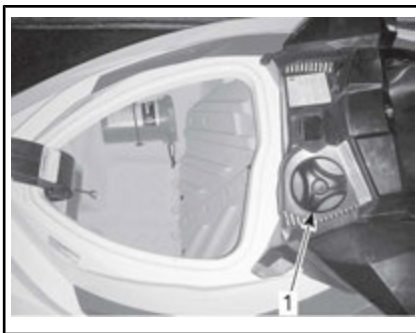
CONFIGURAZIONE TIPICA - UBICAZIONE DEL TAPPO DEL SERBATOIO DEL CARBURANTE
