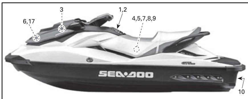
POSIZIONE DELLE ETICHETTE DI SICUREZZA SULLA MOTO D'ACQUA - MODELLI GTS
