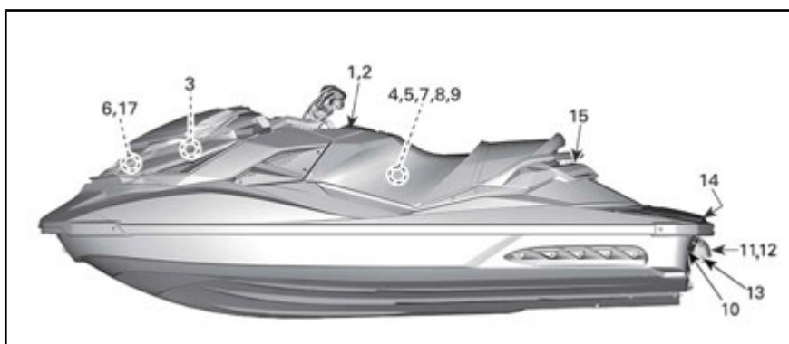
POSIZIONE DELLE ETICHETTE DI SICUREZZA SULLA MOTO D'ACQUA - MODELLI GTR-X
