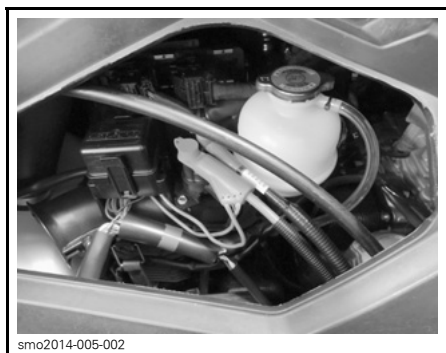
MOTORRUM - VÄNSTER ACCESSPANEL BORTTAGEN
