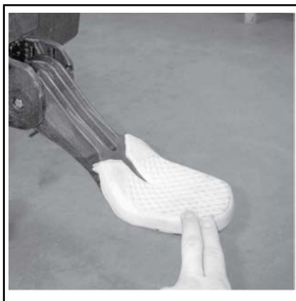
ESTRIBO MANTIDO ABAIXADO PARA EMBARCAR DA ÁGUA
