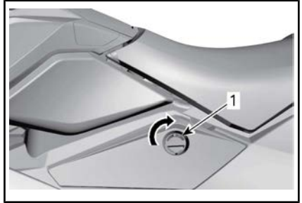
TAMPA DE ACESSO ESQUERDA
