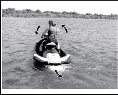
TÍPICA - DIREÇÃO INVERTIDA AO MOVER PARA TRÁS
