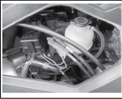
COMPARTIMIENTO DEL MOTOR - TAPA DE ACCESO DE LA IZQUIERDA EXTRAÍDA
