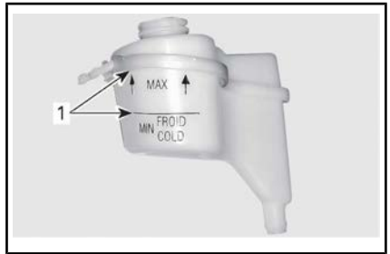
TÍPICA - TANQUE DE EXPANSÃO DO LÍQUIDO DE ARREFECIMENTO
