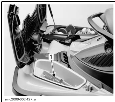
1. Emplacement du support d'extincteur
