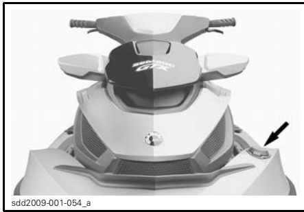
TIPIQUE - EMPLACEMENT DU BOUCHON DU RÉSERVOIR D'ESSENCE
