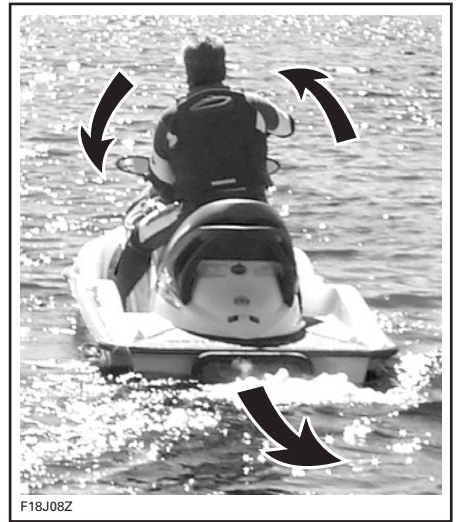
TYPBILD - STYRRIKTINGEN OMKASTAD VID BACKNING
