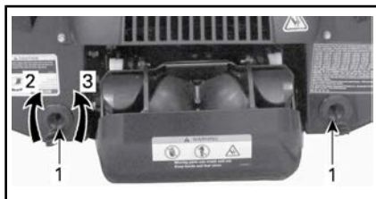
TYPISCH - LOKATIES VAN DE RUIMWATERAFTAPPLUGGEN
