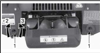
TÍPICO - UBICACIÓN DE TAPONES DE DRENAJE DE LA SENTINA
