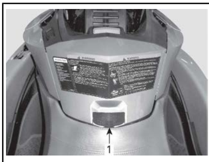
CONFIGURAZIONE TIPICA — VANO PORTAOGGETTI
