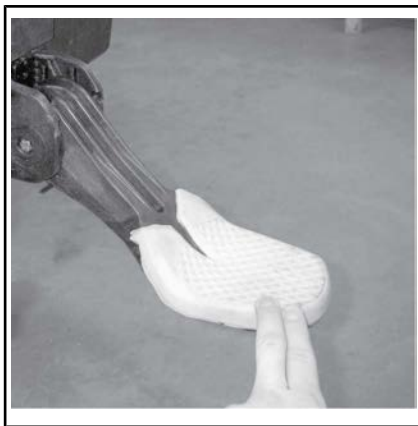
OPSTAPJE NEERGEKLAPT OM VANUIT HET WATER AAN BOORD TE STAPPEN
