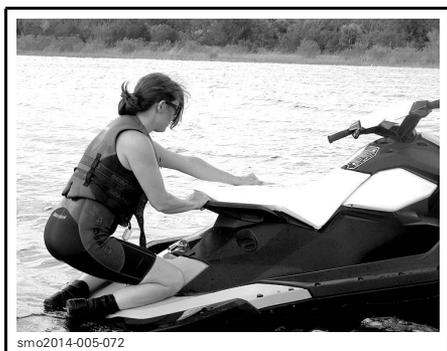
Agripper la courroie du siège pour maintenir son équilibre et avancer jusqu'aux repose-pieds de chaque côté du siège.
