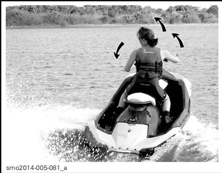
Lorsqu'on tourne le guidon, on fait pivoter la tuyère de la turbine, ce qui dirige la motomarine. Si on tourne le guidon vers la droite, la motomarine tourne à droite, et elle tourne à gauche lorsqu'on tourne le guidon à gauche. Il faut appuyer sur l'accélérateur pour faire tourner la motomarine.
