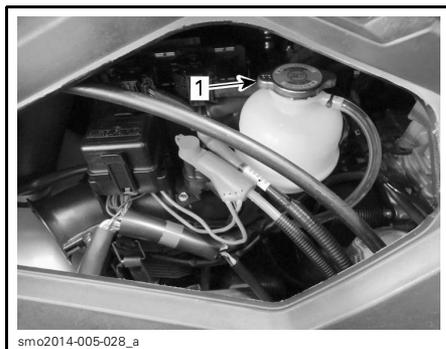
1. Bouchon du réservoir d'expansion
