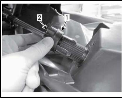
**CABLE DE DIRECCIÓN DESENGANCHADO**
