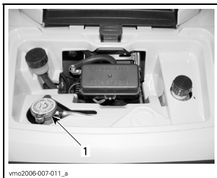
1. Jäähdyttimen täyttöaukon kansi
