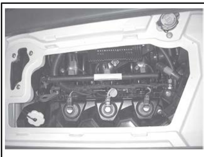
CAIXA DE VENTILAÇÃO REMOVIDA
