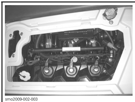
smo2009-002-002_b smo2009-002-003 VENTILASJONSBOKS TATT AV
