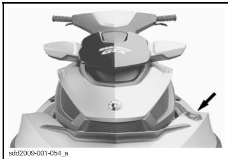
sdd2009-001-054_a TYPEBILDE – PLASSERING AV DRIVSTOFFTANKLOKK
