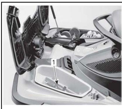
1. Ubicazione del supporto estintore
