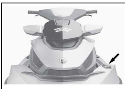
CONFIGURAZIONE TIPICA - UBICAZIONE DEL TAPPO DEL SERBATOIO DEL CARBURANTE
