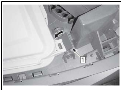
Fase 1: Spingere in basso i dispositivi di bloccaggio per fissare.
