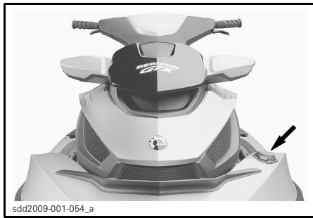
TIPIQUE - EMPLACEMENT DU BOUCHON DU RÉSERVOIR D'ESSENCE
