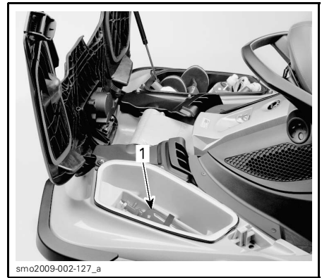
1. Emplacement du support d'extincteur
