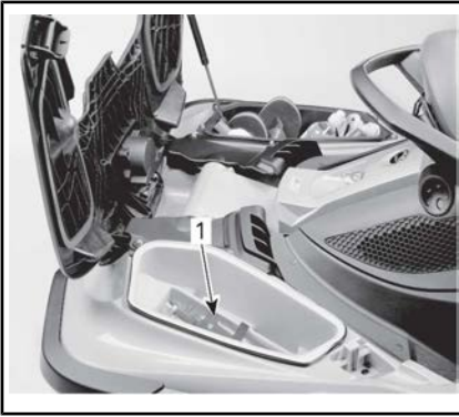
1. Ubicación del soporte para el extintor de incendios
