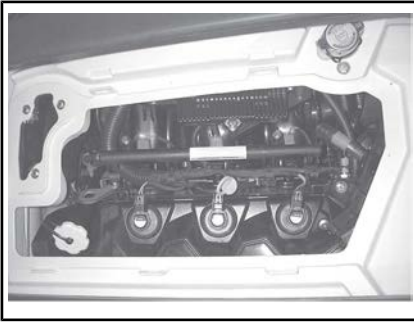
CAJA DE VENTILACIÓN EXTRAÍDA
