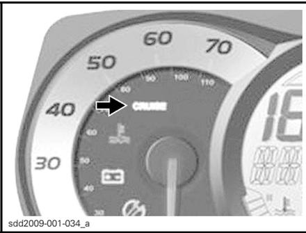
**TYPICAL - CRUISE MODE INDICATOR LIGHT IN SPEEDOMETER**
