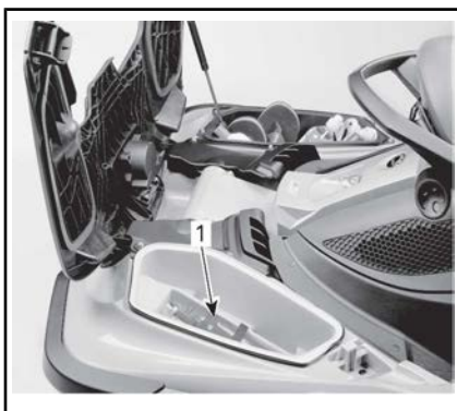
1. Lage des Feuerlöscherhalters
