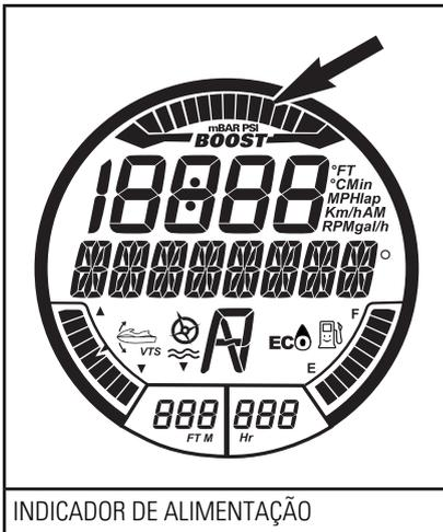
O indicador de alimentação mostra a pressão do coletor do motor fornecida pelo turbocompressor.
