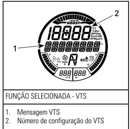
3. Confirme a operação do VTS observando o movimento do indicador de posição do VTS no display digital.
