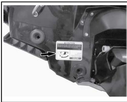
4-TEC™エンジンは、転覆時保護システム(T.O.P.S™)を備えています。ウォータークラフトがひっくり返ると、エンジンは自動的に停止します。
