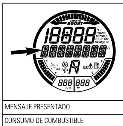
2. Pulse el botón ARRIBA o ABAJO para seleccionar el modo de visualización del consumo de combustible deseado.
