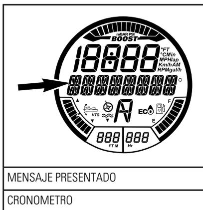
2. Pulse el botón SET (ajuste) para el acceso a la función; el cronómetro se activará y podrá verse en la pantalla.
