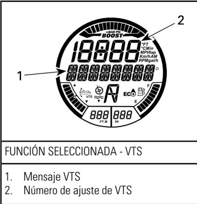
3. Confirme el funcionamiento del sistema VTS a través del movimiento del indicador de posición de VTS en la pantalla digital.
