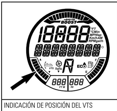
El sistema VTS permite ajustar manualmente la posición de elevación (trim) de la tobera, seleccionar dos posiciones de trim predefinidas y registrar o cambiar posiciones de trim predefinidas en algunos modelos.
