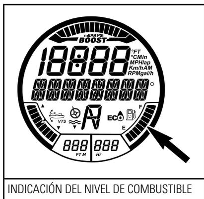
Cuando el depósito está lleno, aparecen encendidas ocho barras del indicador. El segmento superior no se utiliza.
