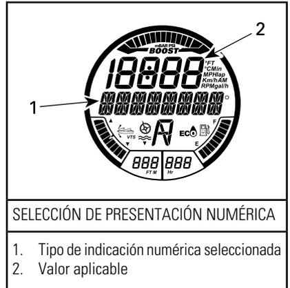
4. Pulse el botón SET (establecer) para seleccionar y guardar la indicación preferida, o espere hasta que la función de presentación quede anulada. La última indicación visible quedará guardada automáticamente.
