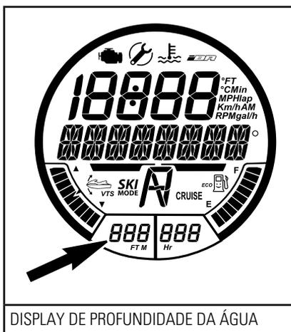
**NOTA:** O display de profundidade da água só está disponível quando um sensor de profundidade estiver instalado e detectado.
