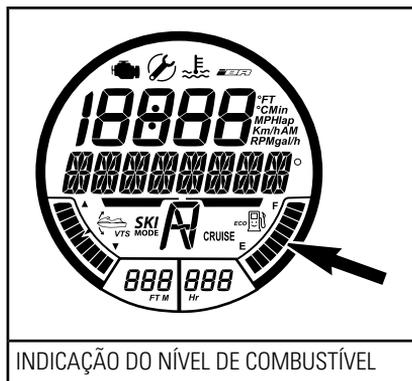
Quando o tanque de combustível está cheio, oito segmentos (barras) do indicador ficam acesas. O segmento superior não é usado.
