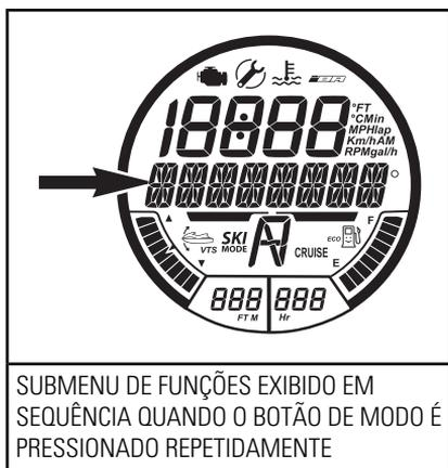
SUBMENU DE FUNÇÕES EXIBIDO EM SEQUÊNCIA QUANDO O BOTÃO DE MODO É PRESSIONADO REPETIDAMENTE
