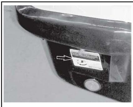
O motor 4-TEC™ possui um sistema de proteção contra emborcar (T.O.P.S.™). Quando o jet vira, o motor desliga automaticamente.
