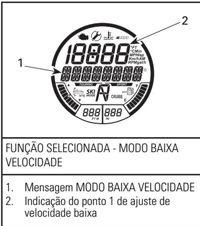
**NOTA:** A mensagem circulante MODO BAIXA VELOCIDADE repete-se enquanto o modo de baixa velocidade estiver ativado. O display numérico volta para a indicação anterior após alguns segundos.
