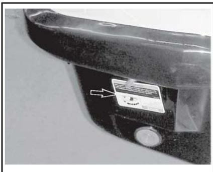
Il motore 4-TEC™ è dotato di un sistema di protezione in caso di ribaltamento (T.O.P.S.™). In caso di capovolgimento dell'imbarcazione, il motore si arresta automaticamente.
