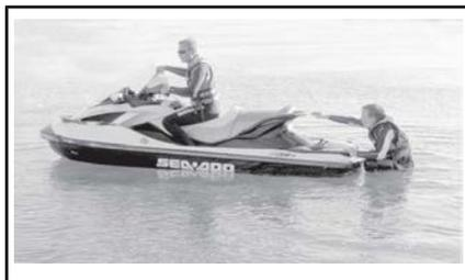
*CONFIGURAZIONE TIPICA - SI INDICA IL MODELLO DOTATO DI SCALINO DI IMBARCO*
