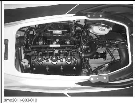
COMPARTIMENT MOTEUR, SIÈGE ENLEVÉ
