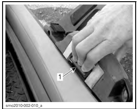
VESILAUTATELINEEN IRROTTAMINEN 1. Paina tästä kahvasta vapauttaaksesi vesilautatelineen
