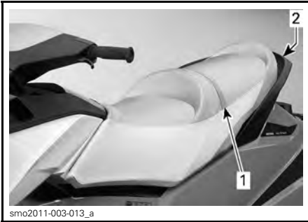
ESIMERKKI - MATKUSTAJAN KÄSIKAHVAT 1. Istuinhihna 2. Muovinen käsikahva
