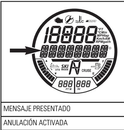
7. Pulse el botón de ajuste para seleccionar la función de activación de anulación. Volverá a presentarse la pantalla normal del indicador.
