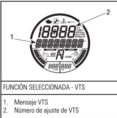
3. Confirme el funcionamiento del sistema VTS a través del movimiento del indicador de posición de VTS en la pantalla digital.
