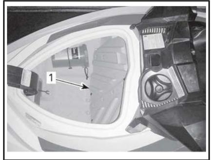
**ACCESO A LA BATERÍA Y LOS FUSIBLES - COMPARTIMENTO DE ALMACENAMIENTO DELANTERO**
