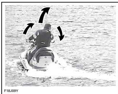
Al girar el manillar se hace pivotar la tobera de la bomba de impulsión que controla la dirección de la embarcación. Al girar el manillar hacia la derecha, la moto acuática girará hacia la derecha y a la inversa. Debe acelerar para girar la embarcación.
