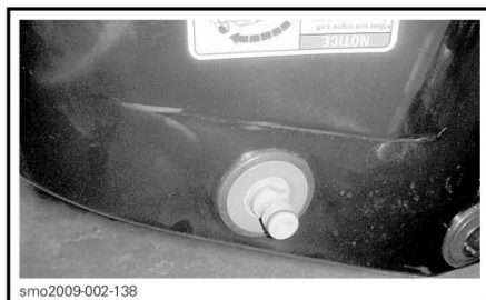
典型图示 — 快速链接软管接头
