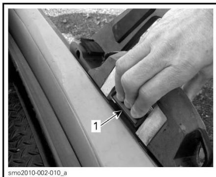
尾波板架拆卸
