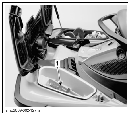
1. Placering av hållare för brandsläckare
