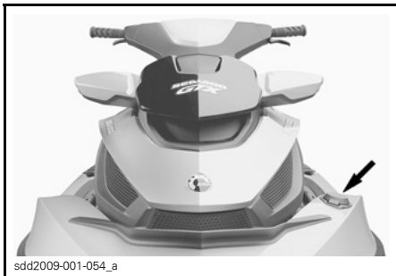
sdd2009-001-054_a TYPEBILDE – PLASSERING AV DRIVSTOFFTANKLOKK
