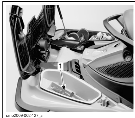
1. Plassering av holder for brannslukningsapparat
