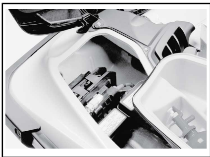
TOEGANG TOT ACCU EN ZEKERINGEN - RECHTER OPBERGBAK VERWIJDERD
