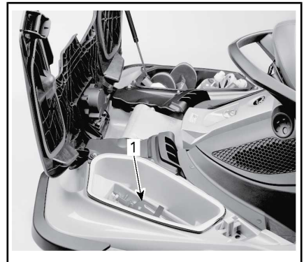
1. Ubicazione del supporto estintore
