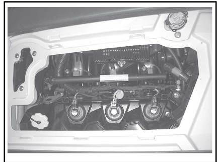
CASSA DI VENTILAZIONE RIMOSSA
